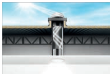
Die spektral selektive Reflexionsbeschichtung sorgt für ca. 99,7 % Lichtspiegelung und reinste Farbwiedergabe – und das bei sehr geringen UV- und Infraroteinträgen. So sind selbst lange Rohrsysteme inklusive 90°-Bögen ohne größere Verluste möglich. © Fotos: Kingspan Light + Air
